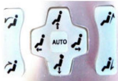
El segundo bloque del mando controla los ajustes de las posición del sillón. Los selectores de la izquierda permiten ajustar la inclinación del respaldo. Accione el botón superior para incorporar el respaldo del sillón y el botón inferior para descenderlo (de 50 a 75°).
